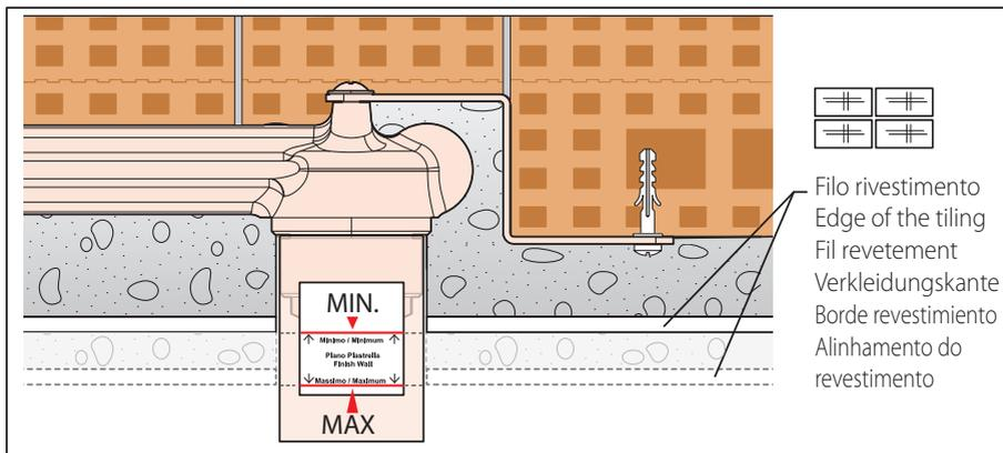
MIN= profondità minima / minimum depth / profondeur minimale / minimale tiefe / profundidad mínima / profundidade mínima
