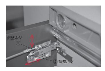
ハンガー金具の調整ネジ①で高さ/調整ネジ②で奥行を 調整し キャビネットが水平に保たれるよう調整してください。
