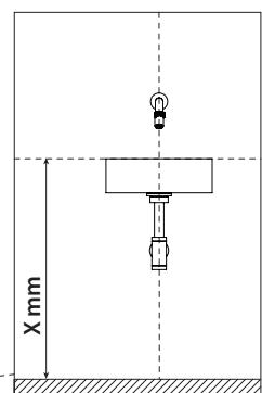
Markieren Sie mit einem Bleistift und mithilfe der Wasserwaage die gewünschte Höhe X des Handwaschbeckens. (Empfohlener Wert: X = 900 mm)
