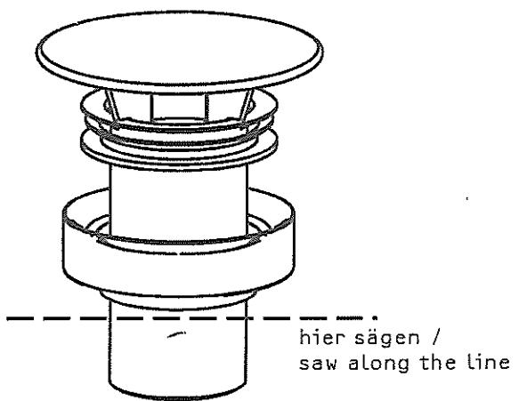
1. Stülpdichtung (4) im Ablaufloch des Beckens einsetzen. Schaftventil (3) von oben durch das Ablaufloch führen.
