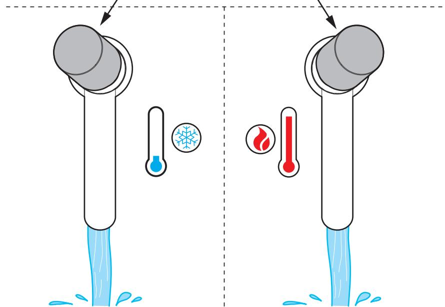
**IT** Al primo utilizzo o dopo un lungo periodo di inutilizzo, non consumare il primo mezzo litro di acqua potabile erogata. Chiudere l'impianto idraulico in caso di prolungata assenza.
