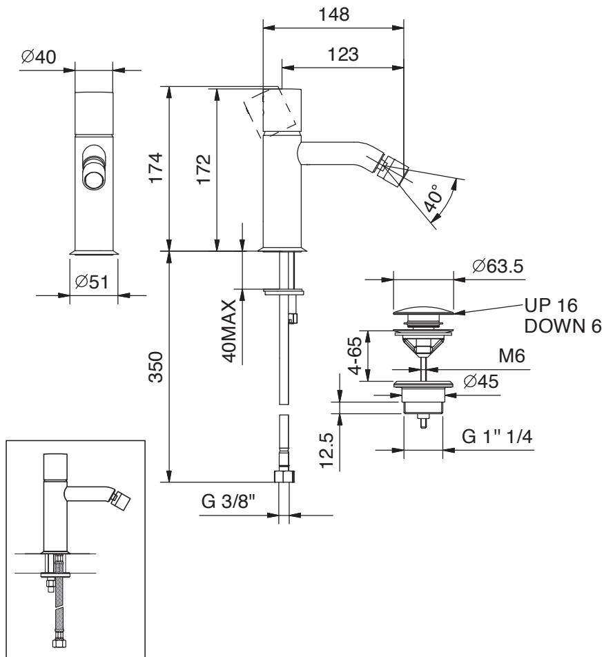
**IT** Questi miscelatori possono essere utilizzati con accumulatori di acqua calda a pressione o con scaldabagni istantaneei.
