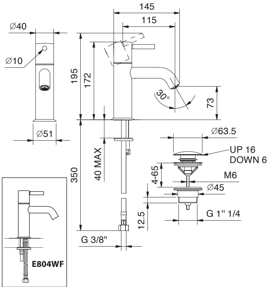
**IT** Questi miscelatori possono essere utilizzati con accumulatori di acqua calda a pressione o con scaldabagni istantaneei.
