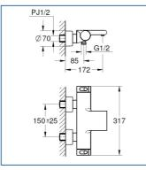
サーモスタットカートリッジ は、市販の工具ですと取り外せない場合がございます。サーモ工具(19332000)を使用していただくか、右記の寸法にあう工具の選定、工具の手直しをお願いいたします。
