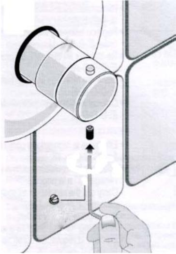
ネジカバーを外し止めネジを緩める。
