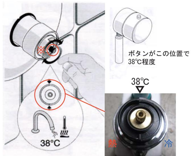
通水しながら先端(※)を回し湯温が変化するか確認してください。
