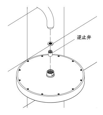
図の位置に逆止弁(節水用)を取り付けることで、 レインシャワーからの水量を抑制することが出来ます。 ※ただし、水量が少ないと水の出が悪くなる場合が ありますのでご注意ください。
