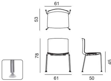
4本脚ベースチェア。ベースはクロームスチール、ラッカー仕上げ、シャイニー仕上げから、シェルは単色ポリプロピレン、標準2色ポリプロピレン (ColorBi®)、反転2色使い、ハイクラスハードレザーまたはハードレザー張りからお選びいただけます。ポリプロピレン製シェルでフレームが塗装仕上げまたはステンレス製のバージョンは屋外でも使用可能。
