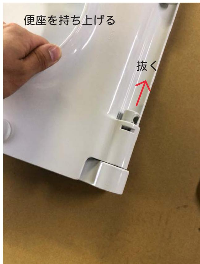
次にヒンジを外します。便座を軽く持ち上げながら矢印の方向に抜いてください。
