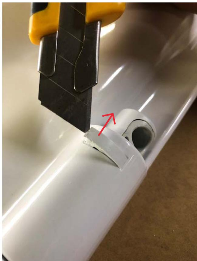
カッターナイフなど、薄くて平たいもので矢印の部分に差し込み引掛けるようにして外します。
