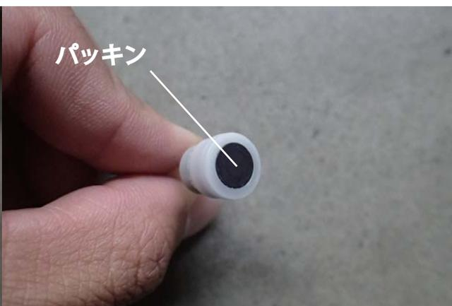
③内部部品 B を外し、先端のパッキンを取り替える
