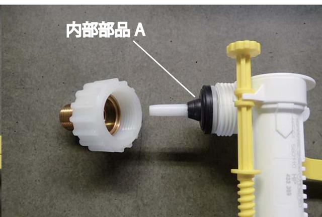
①PC ナットを外し、内部部品 A を外す
