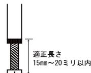
※調整ビスは20ミリ以内で設定し排水栓が適切に開閉する設定してください。
