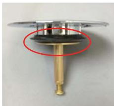
バス用ポップアップ排水栓パッキンがひび割れていたり、硬化していると湯水が溜まらなかったり、ポップアップハンドルの動きが固くなる場合があります。その場合は排水栓パッキンを交換してください。
