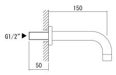
※仕上げ壁の厚みによって吐水口のネジ(G1/2")をカットして接続してください。
