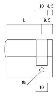
突出寸法Bは扉厚・シリンダーエスカッション厚Aによって異なります。 突出寸法B=シリンダーL寸法 - 扉厚÷2 - シリンダーエスカッションAとなります。 ※偏芯の場合は異なります。
