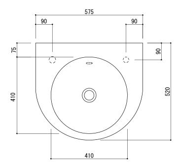
$\bigcirc$  =  $\phi$ 30もしくは $\phi$ 35の水栓取付用穴あけ加工を承ります。 必要な場合、ご注文の際にご指示ください。
