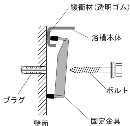
固定金具及びボルトはスチール製ですので錆が発生します。あまり湯水のかからないようにしてください。
