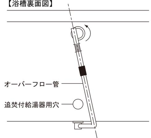
※追焚付給湯器対応モデルの場合、排水金具のオーバーフロー管を図のように斜めに取付けることにより、追焚付給湯器循環金具に干渉せずに取付可能です。
