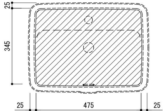
○ =  $\phi 30$ もしくは $\phi 35$ の水栓取付用穴あけ加工を承ります。
