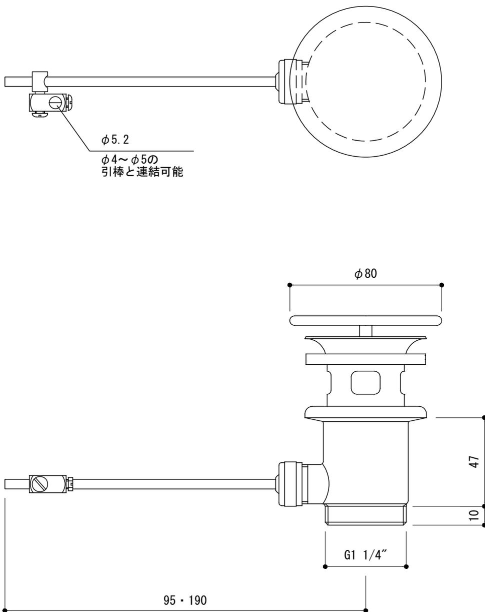
※連結する際、洗面器によっては水栓側引棒の先端部分を少し曲げて接続する必要があります。
