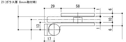
19(ガラス厚12mm取付時) 18(ガラス厚10mm取付時) 17(ガラス厚 8mm取付時) 24(ガラス厚12mm取付時) 22(ガラス厚10mm取付時)
