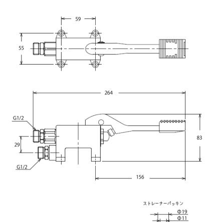
吐水口とフットバルブの接続配管は、施工条件に合わせご用意ください
