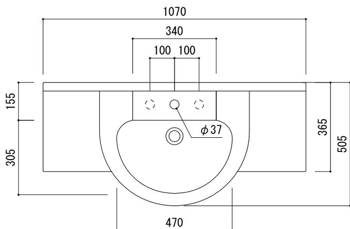
○ =  $\phi 30$ もしくは $\phi 35$ の水栓取付用穴あけ加工を承ります。
