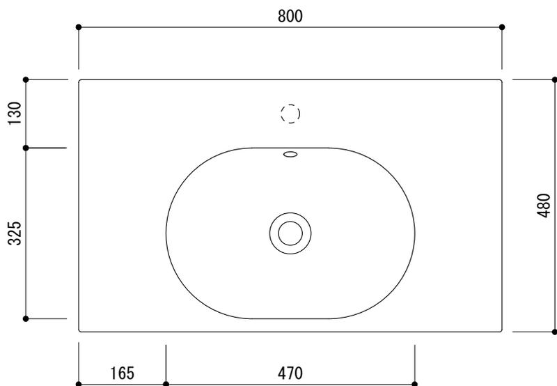
(○) =  $\phi 30$ もしくは $\phi 35$ の水栓取付用穴あけ加工を承ります。
