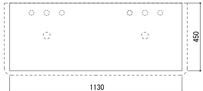
○ =  $\phi 30$ もしくは $\phi 35$ の水栓取付用穴あけ加工を承ります。
