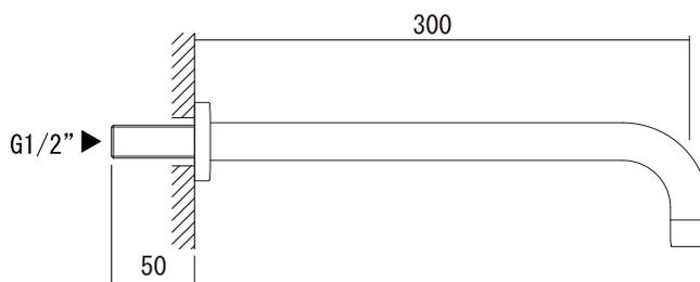
※仕上げ壁の厚みによって吐水口のネジ(G1/2")をカットして接続してください。
