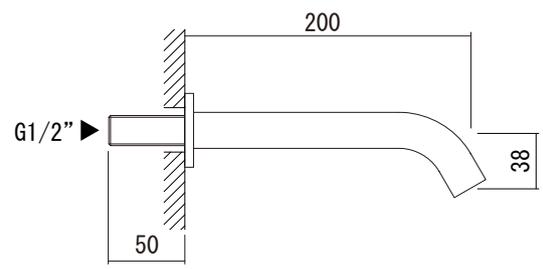
仕上げ壁の厚みによって吐水口のネジ(G1/2")をカットして接続してください。
