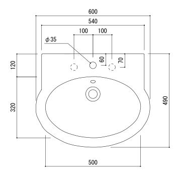
$\bigcirc = \phi$ 30もしくは $\phi$ 35の水栓取付用穴あけ加工を承ります。 必要な場合、ご注文の際にご指示ください。
