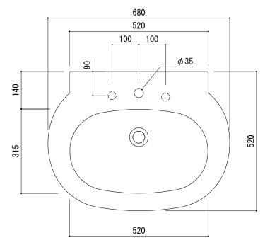
$\bigcirc = \phi$ 30もしくは $\phi$ 35の水栓取付用穴あけ加工を承ります。 必要な場合、ご注文の際にご指示ください。
