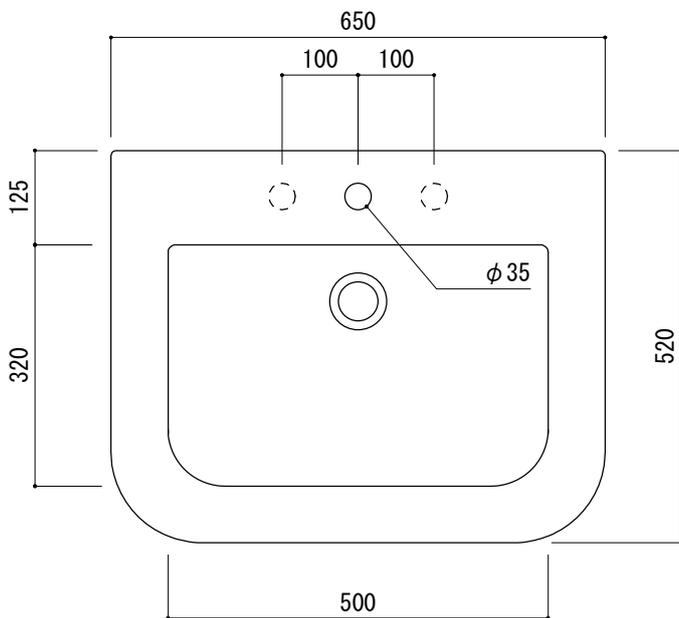
(○) =  $\phi 30$ もしくは $\phi 35$ の水栓取付用穴あけ加工を承ります。
