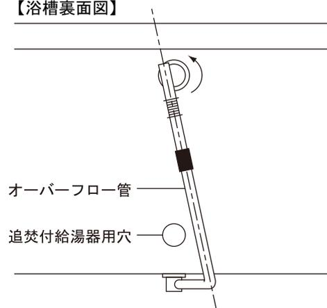
※追焚付給湯器対応モデルの場合、排水金具のオーバーフロー管を図のように斜めに取付けることにより、追焚付給湯器循環金具に干渉せずに取付可能です。
