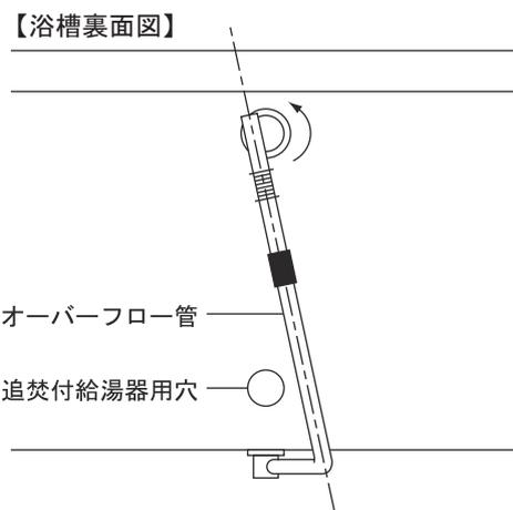
※追焚付給湯器対応モデルの場合、排水金具のオーバーフロー管を図のように斜めに取付けることにより、追焚付給湯器循環金具に干渉せずに取付可能です。
