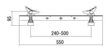
例)FLN72-4371 低床脚:565-585(標準脚:615-635) FLN72-5703 低床脚:505-530(標準脚:560-595)
