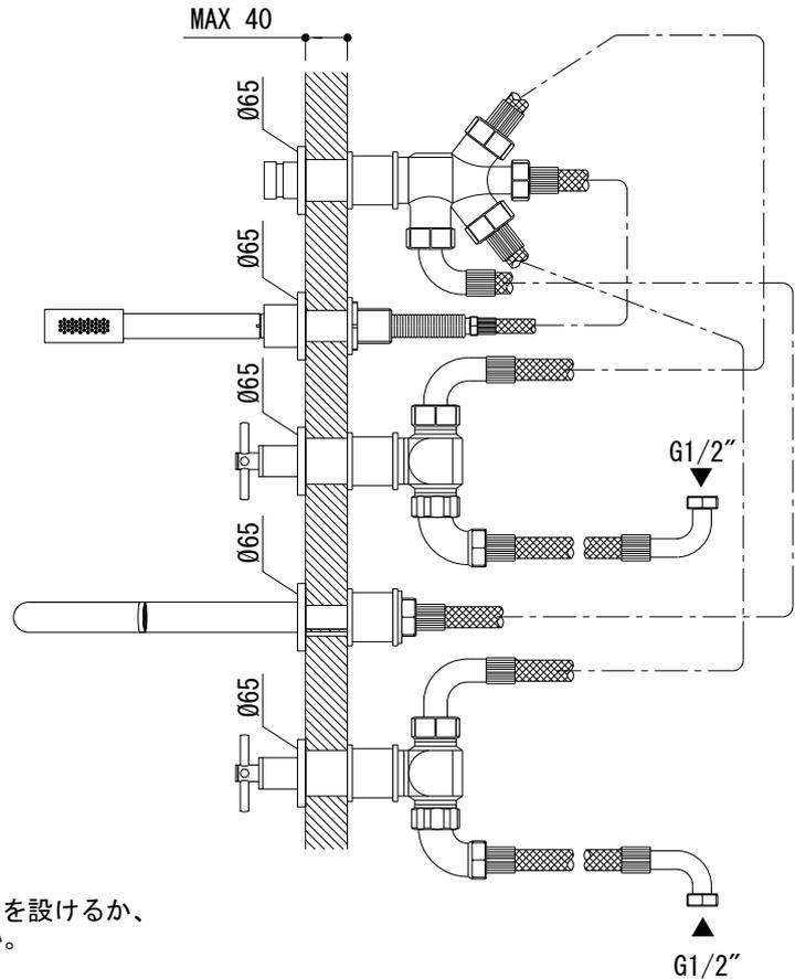
※将来のメンテナンスのために必ず取付け部周辺に点検口を設けるか、取付け部自体の取り外しが可能なよう施工してください。
