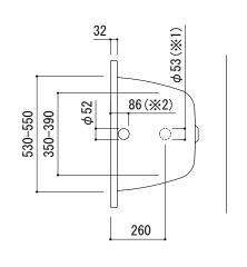
※1:追焚付給湯器用穴付き/穴無しタイプあり 追焚穴付きの場合、U型パッキン(内径 Φ49)付属 ※2:オーバーフロー使用時の満水位置
