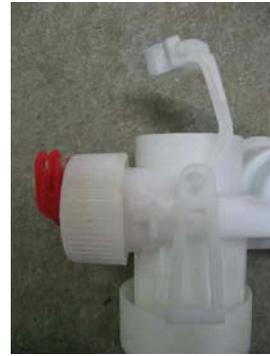
上記イラストを参考に可動部を外し袋ナットを矢印の方向に回し取外すとダイヤフラムを取外すことができます。
