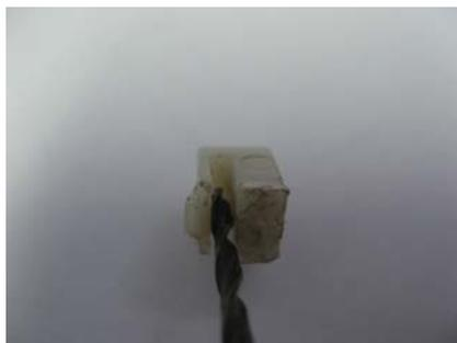
ピンバイスなどドリル刃で残存部分を徐々に切断し、ある程度のところでほじくり出して抜去します。
