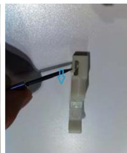
精密ドライバーなど先の細い工具を使用して矢印の方向①に押し込みます。
