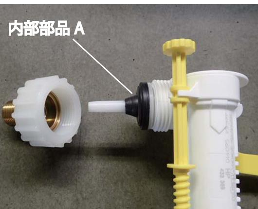
①PC ナットを外し、内部部品 A を外す
