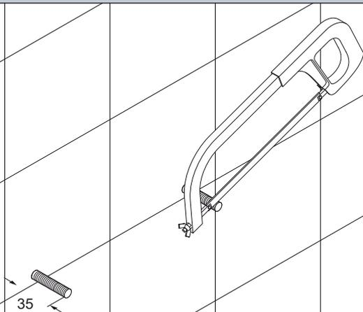
コンシールドシスターン付属のM12ボルトを壁仕上がり面より35mmに設定します。
