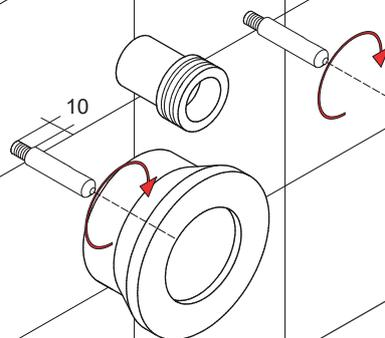
ボルトにキャップボルトを壁から10mmの位置に取付けます。
