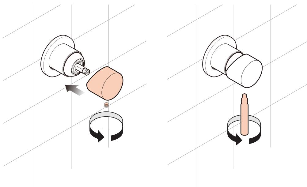
イモネジでハンドルをしっかりと固定し、最後にレバーを取り付ける
