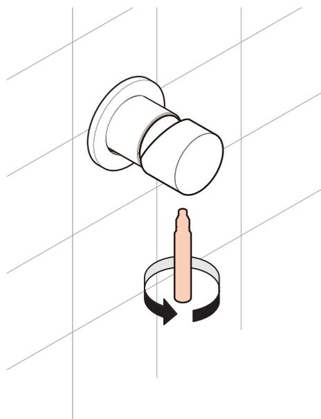
イモネジでハンドルをしっかりと固定し、最後にレバーを取り付ける
