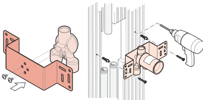
混合栓本体の背面にプレートを取り付け、
