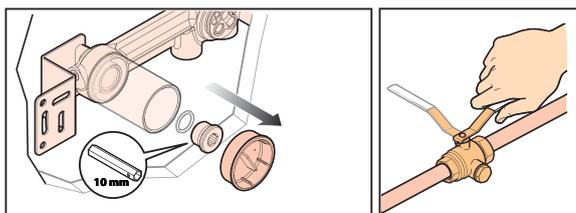
吐水口側プラグを外し、バルブを開け配管の洗浄を行う。
