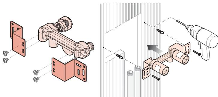
混合栓本体の背面にプレートを取り付け、
