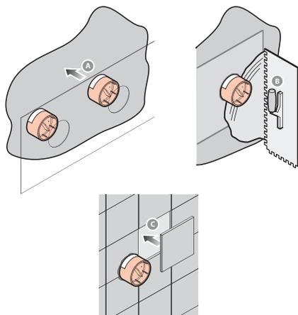
同封の防水シートを接着剤で壁に張り合わせ、石やタイルなど壁面を仕上げる
