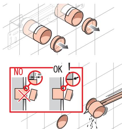
蓋を外し、仕上げ面と面一になるよう養生カバーをカットする
