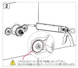
埋込本体と壁の隙間をコーキング材などで 防水処理をします。
