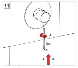
イモネジで操作ハンドルを固定し カバーを取り付けます。
