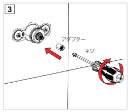
カートリッジの先端(ローレット)にアダプターを 取り付けます。
