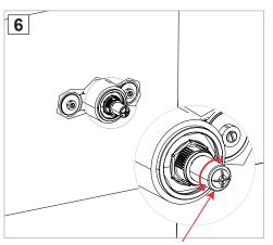
先端を回して温度調節(約38°C)をしてください。
