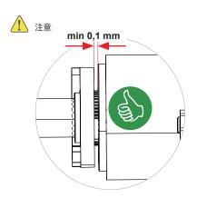
上記のようにサーモスタットと温度調節ストッパーの 間に僅かな隙間を設けて取付てください。
