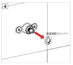
埋込本体に付いている温度調節ストッパーを外します。
