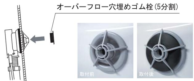
このゴム栓(5分割)はオーバーフローフランジ部に差込むことにより、オーバーフローさせず、より深い水位を確保できます。少量の石鹸水を塗布し確実に差込んでください。
