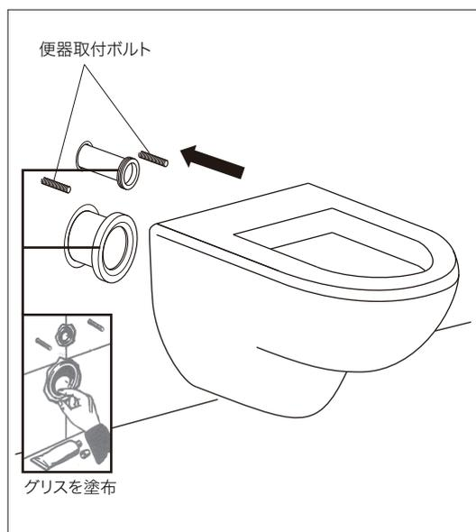
洗浄管、排水管のパッキン部にグリス等の潤滑剤を塗布してから便器本体を洗浄管、排水管、便器取付ボルトに差し込みます。
