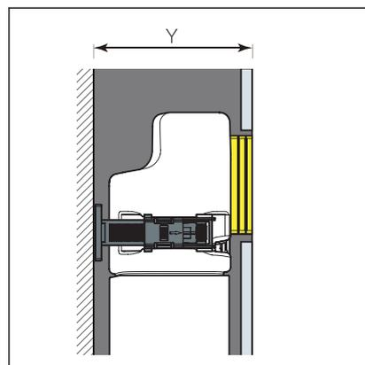
壁の仕上がり面までの寸法(Y)を考慮し、ブラケットを前後調整してください。調整する際はクリップを外し、ブラケットを前後にスライドして調整し、最後にクリップを差し込み、固定します。
