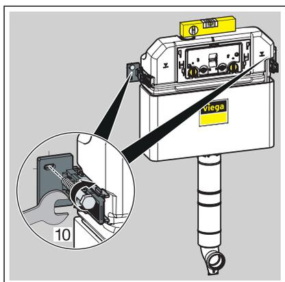
タンクが床に対して水平になるように調整した上でタンクを壁に取り付けます。コンクリート下地の場合は、付属のプラグを使用してください。
