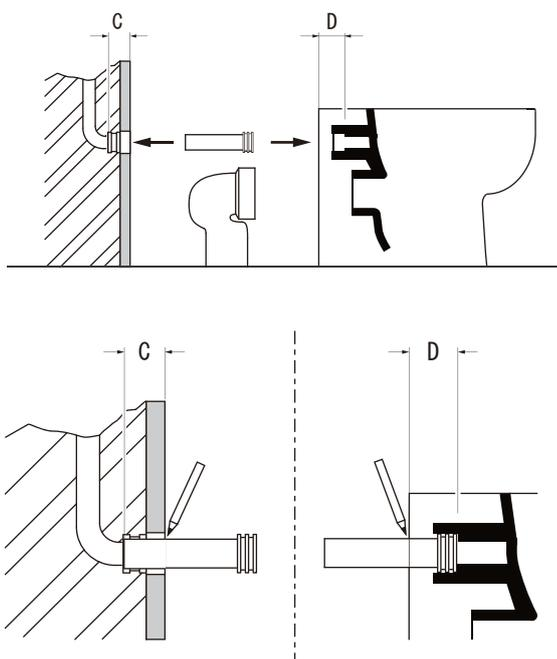
洗浄管をタンク側(壁側)、トイレ側に差込み、それぞれに印をいれる。
