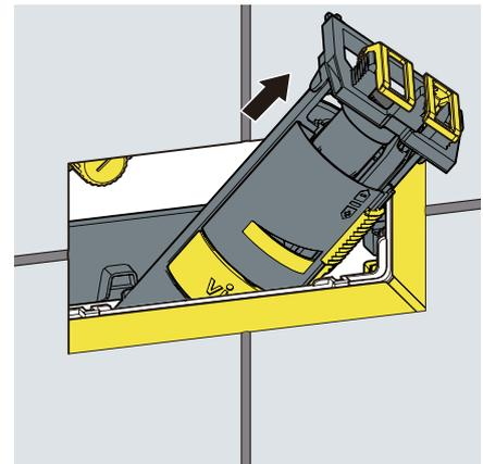
そのまま排水弁を右に傾けてタンク内から抜き取ります。排水弁を戻す場合は取り外しの逆の手順で行ってください。
