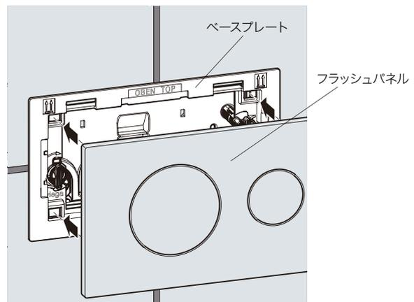
フラッシュパネルをベースプレートに取り付けます。フラッシュパネルの裏面の突起をベースプレートに合わせてはめ込んでください。
