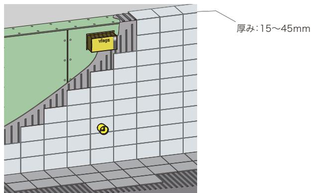
トロヨケ部（操作部と洗浄管）を残し内装壁を仕上げます。内装壁の厚みは、20mm～60mmの範囲としてください。
