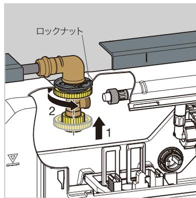
止水栓にロックナットを通し、止水栓をタンクに固定します。
