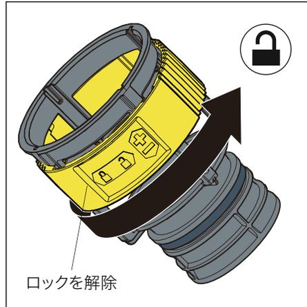
排水弁ホルダーのロック部分 (黄色) を
