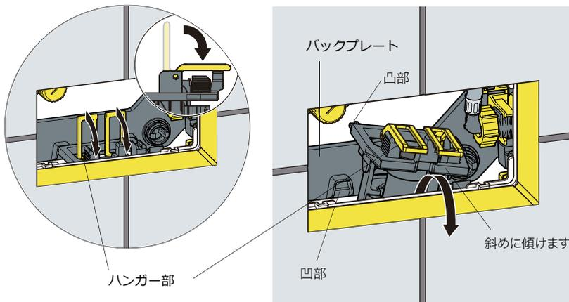
排水弁上部のハンガー部を前方に倒し、斜め手前に傾け排水弁の突起部(凸)をバックプレートの凹部から外します。
