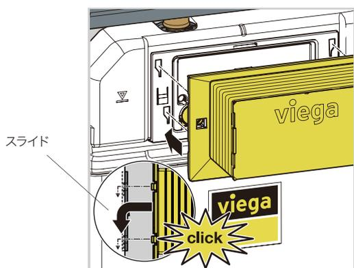
③ -1、③ -2 の項目を参考に、カバープレートを元の位置に取り付け、トロヨケを取り付けます。
