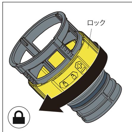
調整後、排水弁ホルダーのロック部分を
