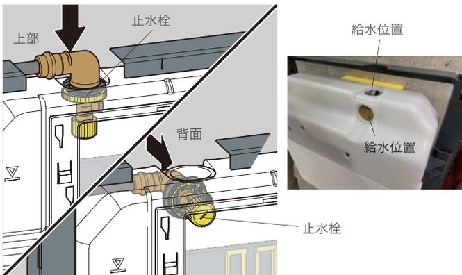
給水位置をタンク上部、タンク背面のいずれかでお選びください。使用する給水位置のカバーを取り外して止水栓をタンク外側から挿入します。
