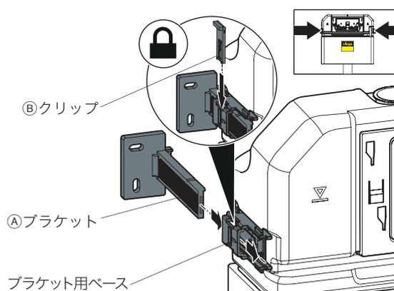
タンクの両側の溝にブラケット用ベースを差し込みます。ブラケット用ベースには矢印が印されていますので、タンク背面から差し込んでください。そこにA ブラケットを背面から差し込み、上面からB クリップを差し込み、固定します。
