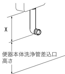
便器本体の洗浄管差込口とフラッシュパネルの高さから、X寸法を算出します。
