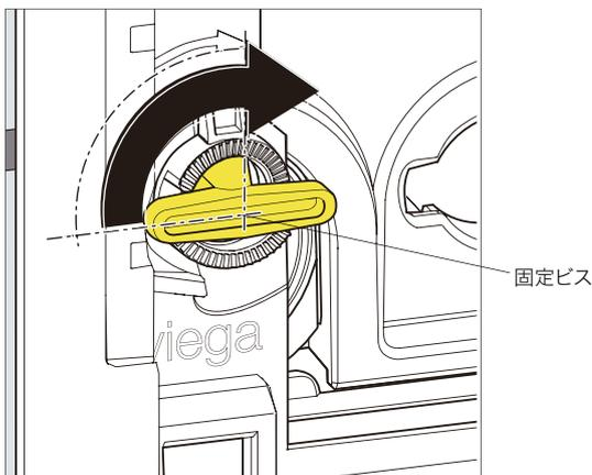
左右両方の固定ビスを矢印の方向に時計回りに90°回転させ垂直にします。
