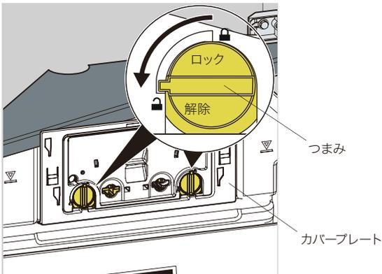
カバープレートのつまみ(左右両方)を反時計回りに90度回転させ、ロックを解除します。
