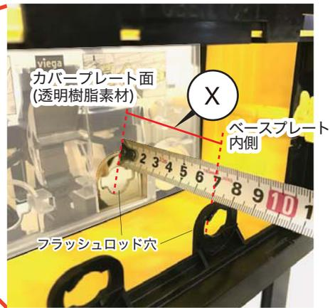
カバープレートのフラッシュロッド穴から、ベースプレートのフラッシュロッド穴までの寸法 X を測ります。
