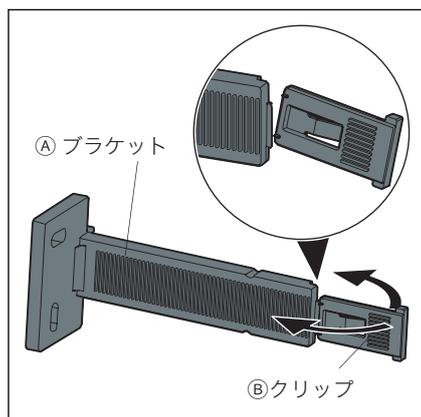
壁固定ブラケットの先端を折り、A ブラケットと B クリップに切り離します。
