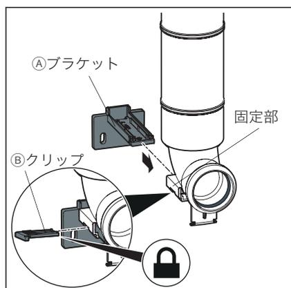
固定部にA ブラケットを差し込み、面からB クリップを差し込み、固定します。
