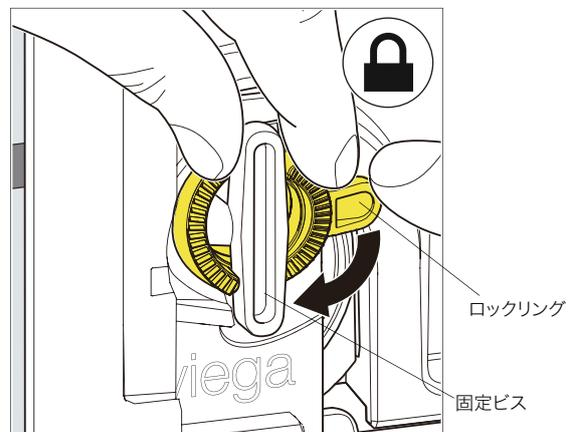
固定ビスは垂直を保持したまま、ロックリングを時計回りに回転させ、固定します。
