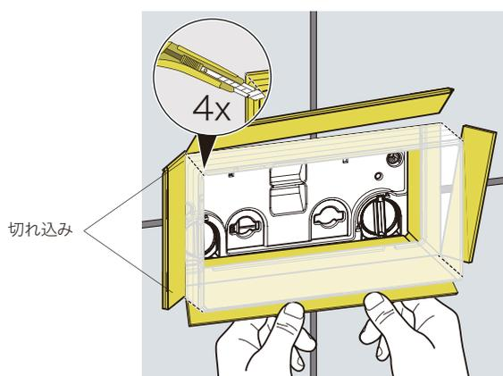
トロヨケの四隅に切れ込みを入れます。トロヨケを外側に折り、折った部分のトロヨケをカッターなどで内装壁と面一になるようにカットしてください。
