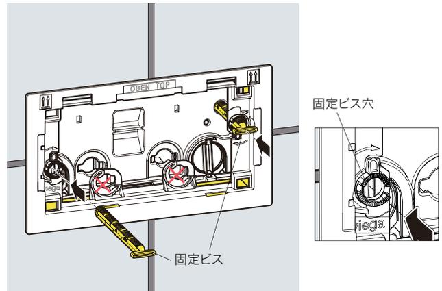
ベースプレート前面の固定ビス穴に固定ビスを差し込みます。固定ビスの端部は図のように水平にした状態で差し込んでください。
