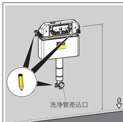
使用する便器本体の洗浄管差込口の高さを考慮し、取付位置を決めて印を入れます。この際、タンク本体の水平を必ず確認してください。
