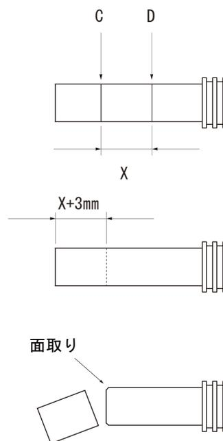
C,D間の寸法(X)を測り、パイプ側先端からX寸法+3mmの位置でパイプをカットする。パイプの切り口はタンクに差込む際、パッキンをキズつける恐れがあるので必ず面取りする。
