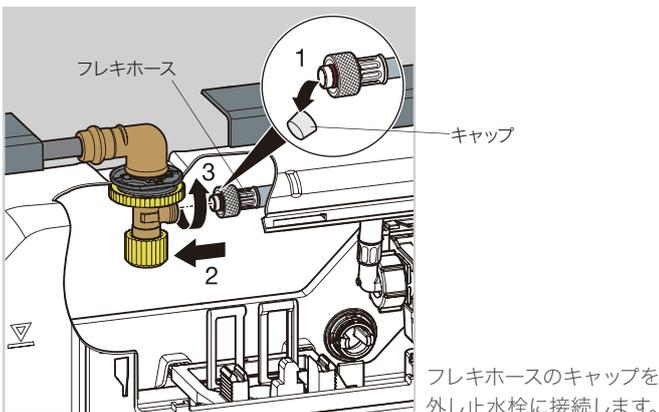
フレキホースのキャップを外し止水栓に接続します。
