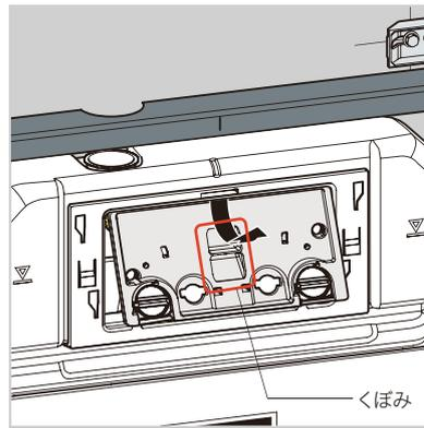
カバープレート中央のくぼみを持ち、下部を手前に引いて取り外します。
