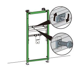
④アングルに洗面器固定用ボルトを取り付けます。 位置は使用する洗面器の取付ボルト穴に合わせます。 止水栓取り出しエルボ(X)の位置を設定します。
