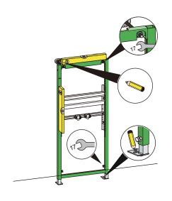
①フレームの設置位置、高さを決定します。 フレームに壁固定ブラケットを取付け、 支持壁、床それぞれの固定位置に印を入れます。
