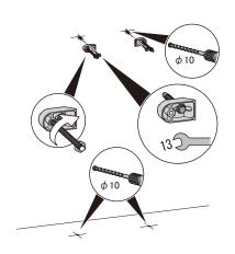
②支持壁、床に下穴を開けプラグを挿入します。 壁固定ブラケットをフレームから外し、 支持壁に取り付けます。
