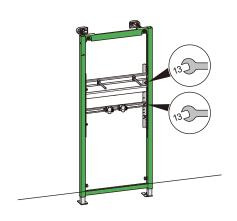
⑤洗面器取付ボルト、止水栓を取り付けた アングルの高さを設定します。
