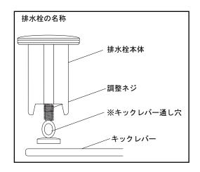
①排水栓が適切に開閉するようにネジの長さを調整してください。
