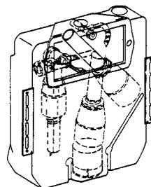
排水弁カートリッジを上方向に引上げ取外します。
