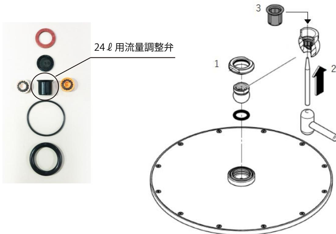
9.5ℓの流量調整弁が標準で組み込まれています。
