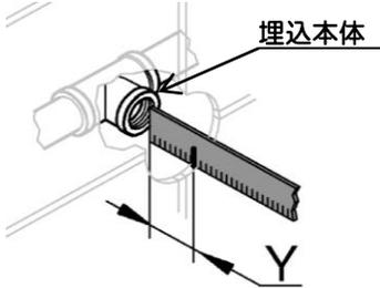
2. ニップルのねじ部側を、上記1で測定した寸法に38mm加えた寸法分を残し切除します。
