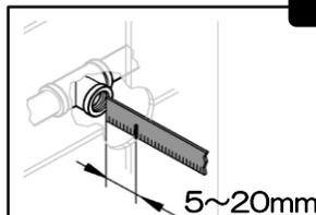
配管は取付穴中心に設置し、
